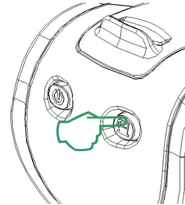
Potrete erogare il caffè solo quando l'indicatore luminoso del pulsante "K" è e rimane blu. Premere questo pulsante per iniziare l'erogazione e premerlo nuovamente per terminare l'erogazione. Non erogare caffè se l'indicatore luminoso blu sta ancora lampeggiando perché la macchina è in fase di riscaldamento. Solo al raggiungimento della temperatura ottimale, si potrà garantire la temperatura ideale del caffè.
